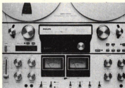
Afb. 2. De recorder is voorzien van twee meters, die zowel in een stand VU als piek kunnen worden gebruikt. Op beide meters zijn twee LED's aangebracht, die +3 dB en +6 dB pieken weergeven.
