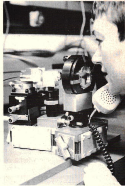
Afb. 6. Demonstratie van het „optofoon”-systeem voor spraakoverdracht in met lichtgeleiders werkende telefoonsystemen (Siemens).
